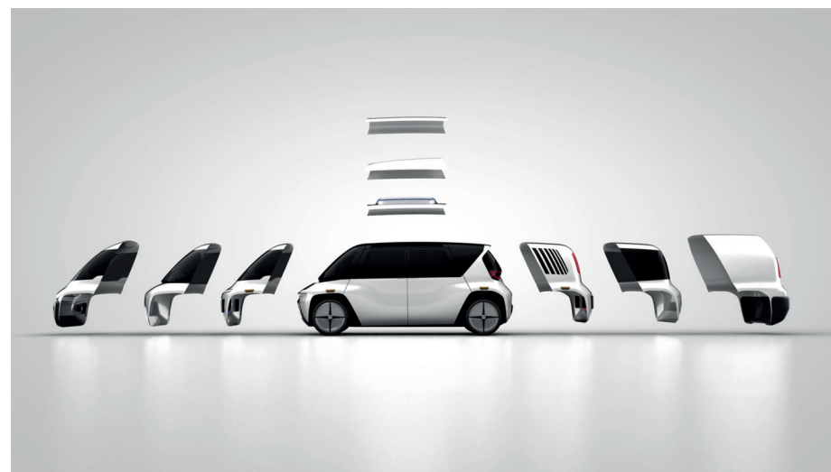
54. EDIT, avec ses modules qui peuvent être insérés à l'avant, à l'arrière et sur le dessus. L'intérieur est aussi modulable, avec possibilité d'enlever le volant en version véhicule autonome.
