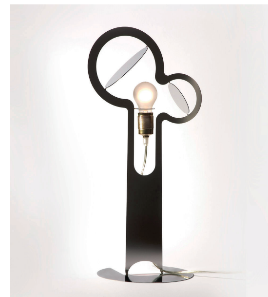
18. Lampe réalisée par Ronen KADUSHIN, selon les principes de l'Open Design : une feuille de métal est découpée selon des plans disponibles en ligne sur une découpeuse à commande numérique.
