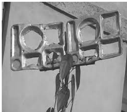
Antenne TV fabriqué à partir d'un plateau en métal
